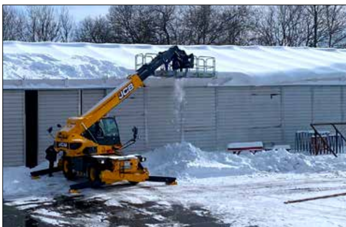
Beim Beräumen von großen Hallendächern leistete der neue Teleskopplader der Stadttochter KLW gute Dienste. Foto: René Weißbach
